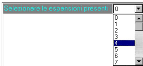
In seguito cliccando sul pulsante a fianco “Config. Ingressi”, sara' possibile abilitare/disabilitare ogni singola espansione e selezionare il tipo di espansione/i (Modulo I/O, DLC4008, solo ingressi ecc...).
