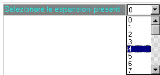
In seguito cliccando sul pulsante a fianco "Config. Ingressi", sarà possibile abilitare/disabilitare ogni singola espansione e selezionare il tipo di espansione/i (nel caso dell'espansione 0404 si tratta di un modulo I/O).
