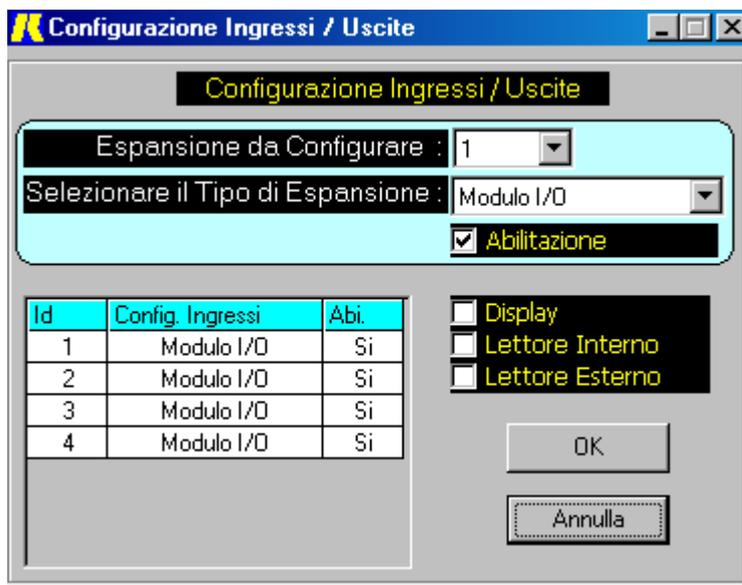
Una volta selezionate e collegate le espansioni 0808D, nel programma saranno utilizzabili gli inputs e gli outputs messi a disposizione dalla/dalle espansione/i come nella seguente tabella :
